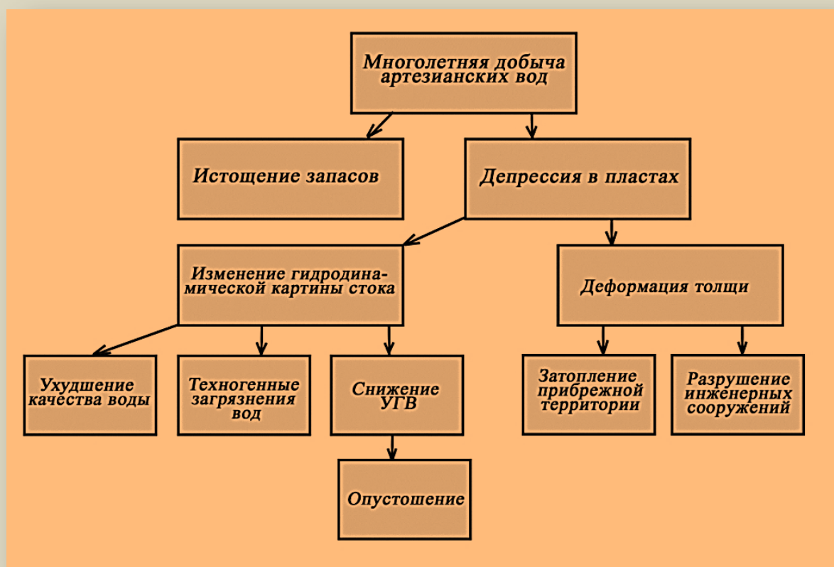
Схема последствий многолетней добычи подземных вод
